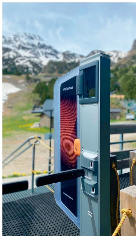
がゲートの読み取り範囲に入ると自動接続され、リフト券の有効性が確認されます。有効な場合、遮断バーが開放され、ハンズフリーでゲートを通過できます。
